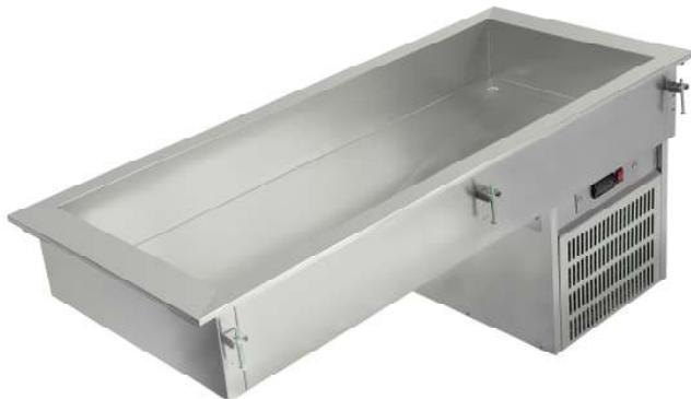
VASCHE REFRIGERATE • Vasche profondità 160 mm per collocazione bacinelle GN 1/1 con profondità massima di 150 mm, con sistema di refrigerazione statico. • Gas refrigerante R600a. Morsetti speciali ideali al fissaggio corretto al piano. Temperatura di esercizio della vasca: 2 °C / 8 °C. 230V/1/50Hz.
