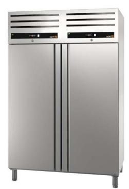
guarnizione smontabile. Isolamento espanso da 60 mm di spessore senza CFC. Compressore ermetico ambiente a 43°C. Refrigerante ecologico R-290a per positivo, idrocarburi (HC). Evaporatore rame/alluminio verniciato. Ventilazione forzata. Refrigerazione ventilata. Evaporazione acqua di sbrinamento automatica. Armadio combinato con due gruppi motore e due celle separate:
