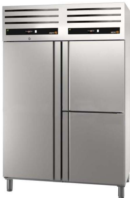
Interno-esterno in acciaio inox. Interni con angoli arrotondati. Porte chiusure automatica e guarnizione smontabile. Isolamento espanso da 60 mm di spessore senza CFC. Compressore ermetico ambiente a 43°C. Refrigerante ecologico R-290a per positivo, idrocarburi (HC). Evaporatore rame/alluminio verniciato. Ventilazione forzata. Refrigerazione ventilata. Evaporazione automatica acqua di sbrinamento.
