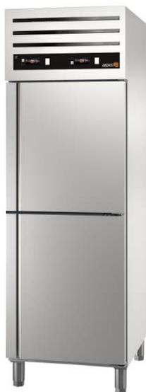
Interno-esterno in acciaio inox. Interni con angoli arrotondati. Porte chiusure automatica e guarnizione smontabile. Isolamento espanso da 60 mm di spessore senza CFC. Compressore ermetico ambiente a 43°C. Refrigerante ecologico R-290a per positivo, idrocarburi (HC). Evaporatore rame/alluminio verniciato. Ventilazione forzata. Refrigerazione ventilata. Evaporazione acqua di sbrinamento automatica.
