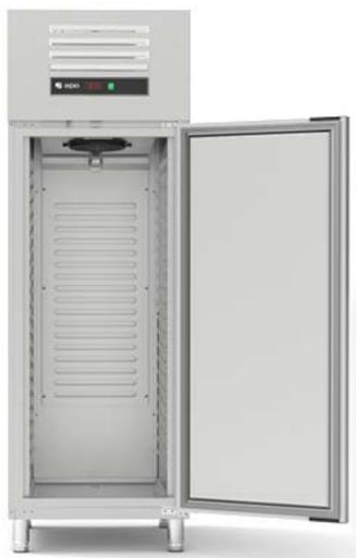
Interno-esterno in acciaio inox. Interni con angoli arrotondati. Porte chiusure automatica e guarnizione smontabile. Isolamento espanso da **80 mm** di spessore senza CFC. Compressore ermetico tropicalizzato ambiente a **43°C**. Refrigerante ecologico **R-290a** idrocarburo (HC). Ventilazione forzata. Refrigerazione ventilata.
