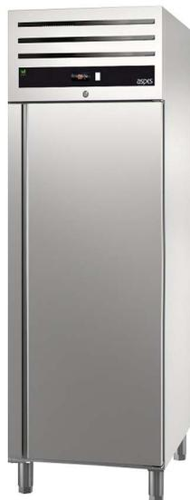
Interno-esterno in acciaio inox. Interni con angoli arrotondati. Porte chiusure automatica e guarnizione smontabile. Isolamento espanso da 60 mm di spessore senza CFC. Evaporatore rame/alluminio verniciato. Ventilazione forzata. Refrigerazione ventilata. Controllo della temperatura e lettura digitale. Temperatura di esercizio -2+8°C. Piedi regolabili in altezza inox. Alimentazione elettrica: 230V.
