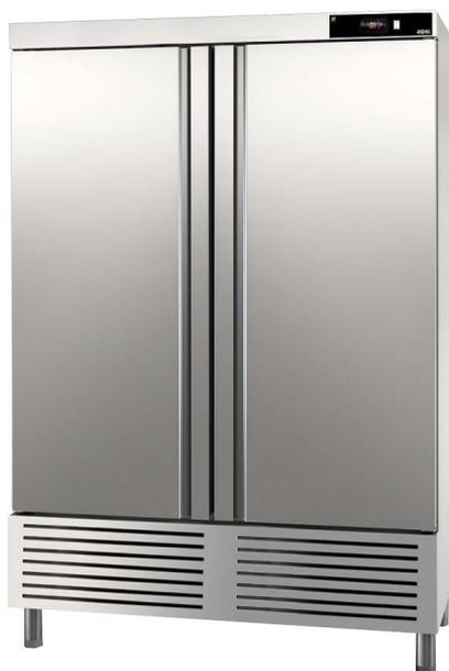
Interno-esterno in acciaio inox. Interni con angoli arrotondati. Porte chiusure automatica guarnizione smontabile. Isolamento espanso da 60 mm di spessore senza CFC. Compressore ermetico ambiente a 43°C. Refrigerante ecologico R-290a idrocarburo (HC). Evaporatore rame/alluminio verniciato. Ventilazione forzata. Refrigerazione ventilata. Evaporazione automatica acqua di sbrinamento. Controllo della temperatura e lettura digitale.
