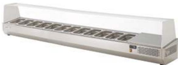
Vetrine costruite in acciaio inox. Isolamento in poliuretano espanso con densità 42kg mc privo di CFC. Gruppo refrigerante statico con serpentina annegata nella vasca. Temperatura di lavoro a (+2°+8°C) ambiente fi no 38°C. Controllo elettronico della temperatura con lettura digitale.
