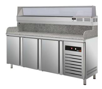
automatica e guarnizione smontabile. Isolamento espanso da 60 mm di spessore senza CFC. Compressore ermetico ambiente a 43°C. Refrigerante ecologico R-290a privo di CFC. Evaporatore rame/alluminio verniciato. Ventilazione forzata. Refrigerazione ventilata. Evaporazione automatica. Controllo e lettura temperatura digitale. Temperatura di esercizio –2+8°C.
