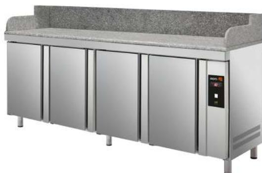
Pannello comandi incorporato, completo di interruttore generale e termostato di lettura programmabile. Ventilazione forzata. Refrigerazione ventilata. Evaporazione automatica. Controllo della temperatura e lettura digitale. Temperatura di esercizio +2+8°C. Piedi regolabili in altezza inox. Cremagliere e guide inox. Alimentazione elettrica: 230V. Dotazione standard tavoli: 1 griglia rilsan e 1 coppia guide per porta OPTIONAL: Cassettiere, piani con o senza alzatine posteriori o senza piano.
