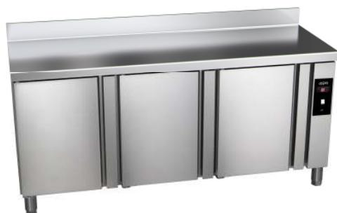
Pannello comandi incorporato, completo di interruttore generale e termostato di lettura programmabile. Ventilazione forzata. Refrigerazione ventilata. Evaporazione automatica. Controllo della temperatura e lettura digitale. Temperatura di esercizio -2+8°C. Piedi regolabili in altezza inox. Cremagliere e guide inox. Alimentazione elettrica: 230V. Dotazione standard tavoli: 1 griglia rilsan e 1 coppia guide per porta OPTIONAL: Cassettiere, piani con o senza alzatine posteriori o senza piano.
