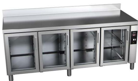
Pannello comandi incorporato, completo di interruttore generale e termostato di lettura programmabile. Ventilazione forzata. Refrigerazione ventilata. Evaporazione automatica. Controllo della temperatura e lettura digitale. Temperatura di esercizio -2+8°C. Piedi regolabili in altezza inox. Cremagliere e guide inox. Alimentazione elettrica: 230V. Dotazione standard tavoli: 1 griglia rilsan e 1 coppia guide per porta OPTIONAL: Cassettiere, piani con o senza alzatine posteriori o senza piano.
